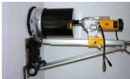
Příprava jádrového vrtání
