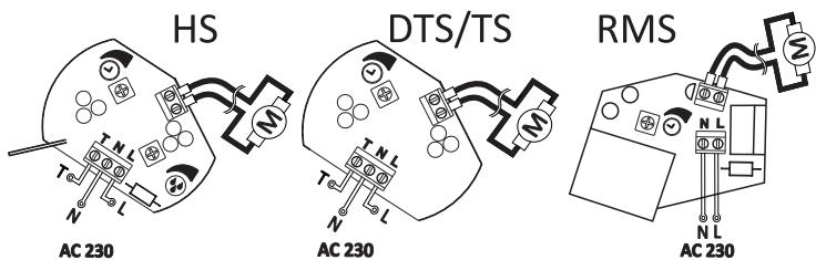
U ventilátorů s elektronickým řídícím systémem (provedení TS, HS, RMS) je možné nastavit čas provozu ventilátoru potenciometrem pomocí šroubováku.
