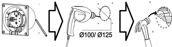
Instalace ventilátoru / Fan installation / Установление вентилятора
