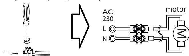
Elektrické zapojení verze TS, HS a RMS
