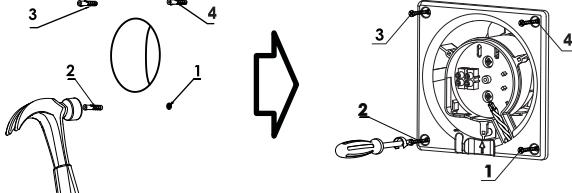
Protáhněte vodič krytkou a upevněte jej do držáku vodiče
